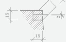
Der unter Druckring steckt auf einem Betonpfeiler. Die Kräfte in den Sparren werden über den Ring in die Vertikale umgeleitet.
